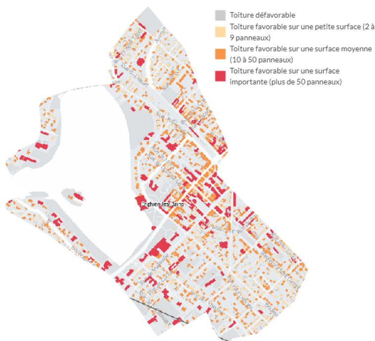
Gisement solaire des toitures
